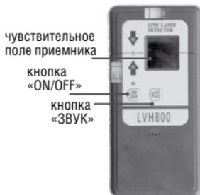
**ВНИМАНИЕ!** Детектор определяет модулируемый сигнал от XLiner Combo и не определяет перманентное лазерное излучение или точку. Следите за чистотой поверхности чувствительного поля приемника, протирайте мягкой тряпкой, не используйте химически активные жидкости (в т.ч. спирт, растворитель).
