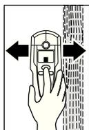
Равномерно перемещайте измерительный инструмент с нажатой клавишей «Zoom» 4 по всей площади, не отрывая его от поверхности и не изменяя усилия прижатия. Во время измерения фетровые подкладки 8 должны постоянно прилегать к поверхности.
