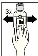
Для точной локализации расположения объекта нажмите клавишу «Zoom» 4 и держите ее нажатой, пока Вы повторно передвигаете измерительный инструмент над объектом. На дисплее показывается функция Zoom d. Над серединой металлического объекта значении индикатора Zoom e имеет наибольшую величину.
